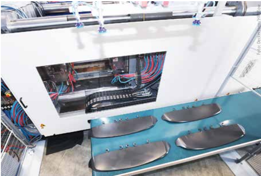
Die 13.000-kN-Maschine diente als Demonstrator für die Möglichkeiten der elektrisch betätigten Heißkanalsysteme von HRSflow.
