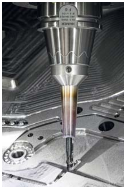
Beim Fräsen des Spritzgießwerkzeugs für das Face Shield wurden Werkzeugaufnahmen und Fräser von Haimer eingesetzt: hier der schlanke und dennoch kraftvolle Power Mini Shrink.
